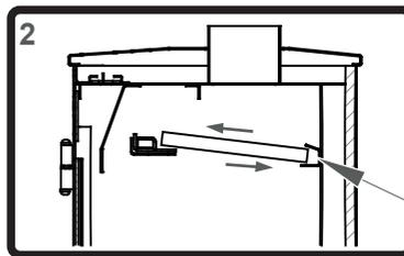
Colocar como indica la Fig. 2 los ladrillos refractarios sobre los soportes delanteros y luego deslizar hacia atrás hasta hacer tope con el soporte trasero.
