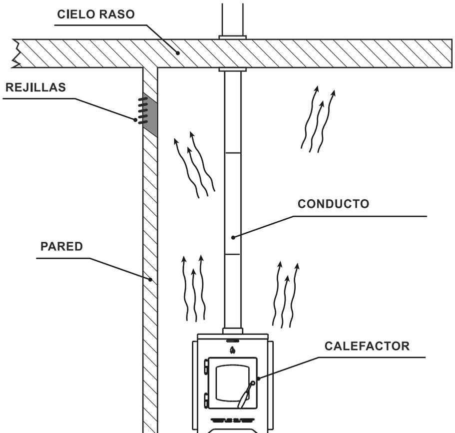
**IMPORTANTE:** Para ambientes contiguos, se puede hacer aberturas a la pared o techo (tratar de que sean en las partes más elevadas) y colocar forzadores de aire. De esta manera se ahorra la instalación de los conductos y de los derivadores de calor.
