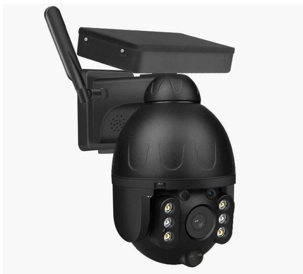
La cámara solar inteligente consta de una pantalla fotovoltaica de 8 W que capta la radiación solar durante el día y la convierte en electricidad, siendo la fuente de energía principal. Por la noche, utiliza la energía que fue almacenada en 6 baterías 18650.
